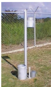
Pluviòmetre: mesura l'aigua caiguda per metre quadrat
